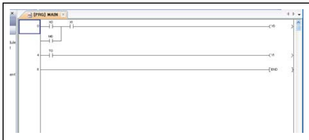
Abb. 3-35: Anzeige des zu ändernden Kontaktplanblocks
